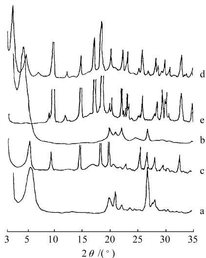
a. 未改性蒙脱土; b. 季铵盐改性蒙脱土; c. 己内酰胺与未改性的蒙脱土经常规熔融混合得到的产物; d. 己内酰胺与改性蒙脱土经熔融混合反应后的产物; e. 己内酰胺单体
