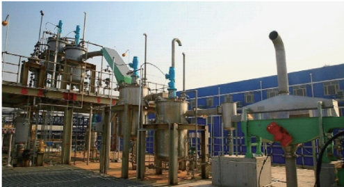
图 9 衣康酸酯橡胶絮凝干燥线
