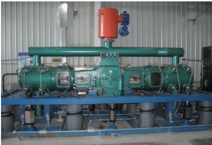
图 7 往复式压缩机实验台
