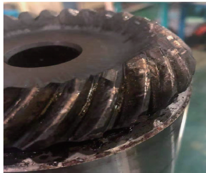
图8 故障角度头齿轮拆卸图
