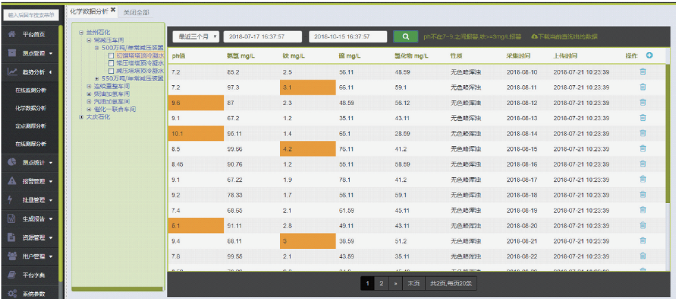
图7 某石化常减压车间500万t/a常减压装置初馏塔塔顶冷凝水化学监测数据
