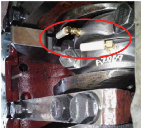
图 7 传感器实际安装
