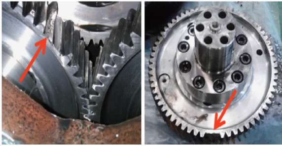
图 17 被破坏的齿轮 Fig. 17 The broken gear
