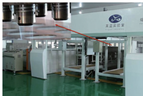
图 6 熔体微分静电纺丝产业化生产线 [38]
