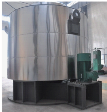
图5 转子直径3.5 m的超重力反应器照片 [8]
