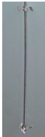
图3 45^{\circ} 平板成组固定方式
