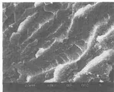
图 4 改性纳米 \text{CaCO}_3 /环氧树脂复合材料冲击断面
