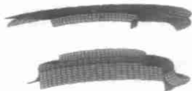
图 4 气囊-上下盖板接触单元模型
