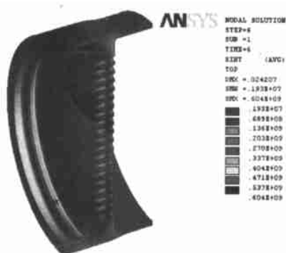
图 4 管板管侧的应力强度云图
