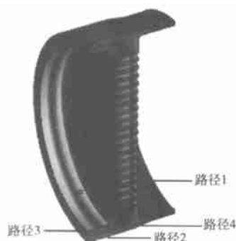
图 5 管板应力强度和路径图
