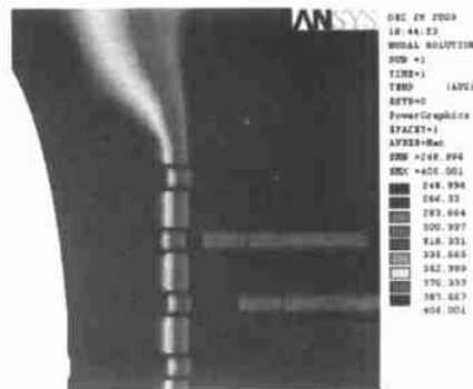
图 2 进口端管板和部分管子温度场云图
