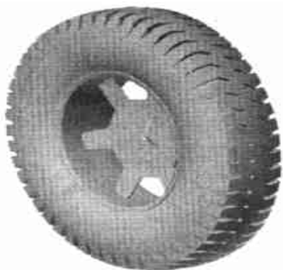
图8 横向花纹块的全胎模型
