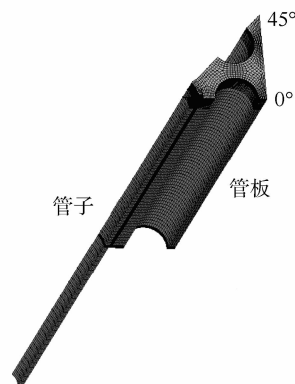
图3 胀接接头有限元分析模型
