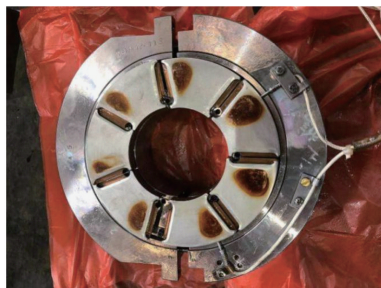
图 2 烧坏的主推力轴承瓦
