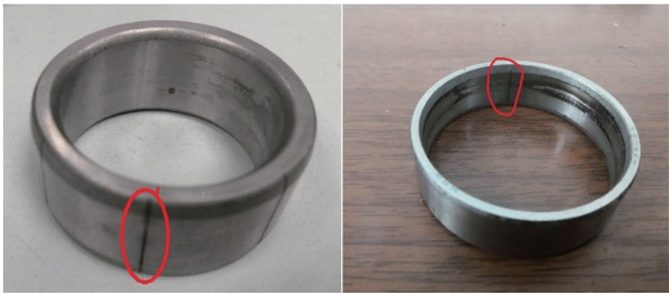
图 4 轴承缺陷示意图 Fig. 4 Bearing defect diagram
