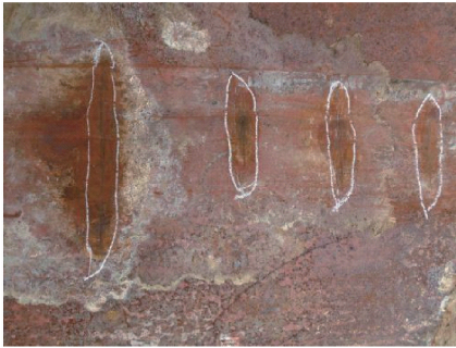
图 8 氯化物和硫化物应力腐蚀开裂腐蚀形貌
